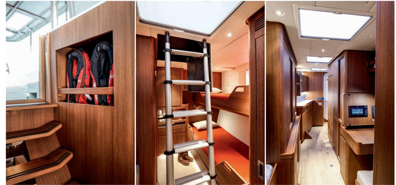
Gut gerüstet: Im Notfall – der Eigner erlitt mit seiner letzten Yacht Schiffbruch – stehen Rettungswesten am Niedergang und in jeder Kabine bereit, die alle über Notluken mit Ausziehleitern verfügen. Im Vorschiff befinden sich E-Panels (r.), zusätzlich zum Salon (u.).
