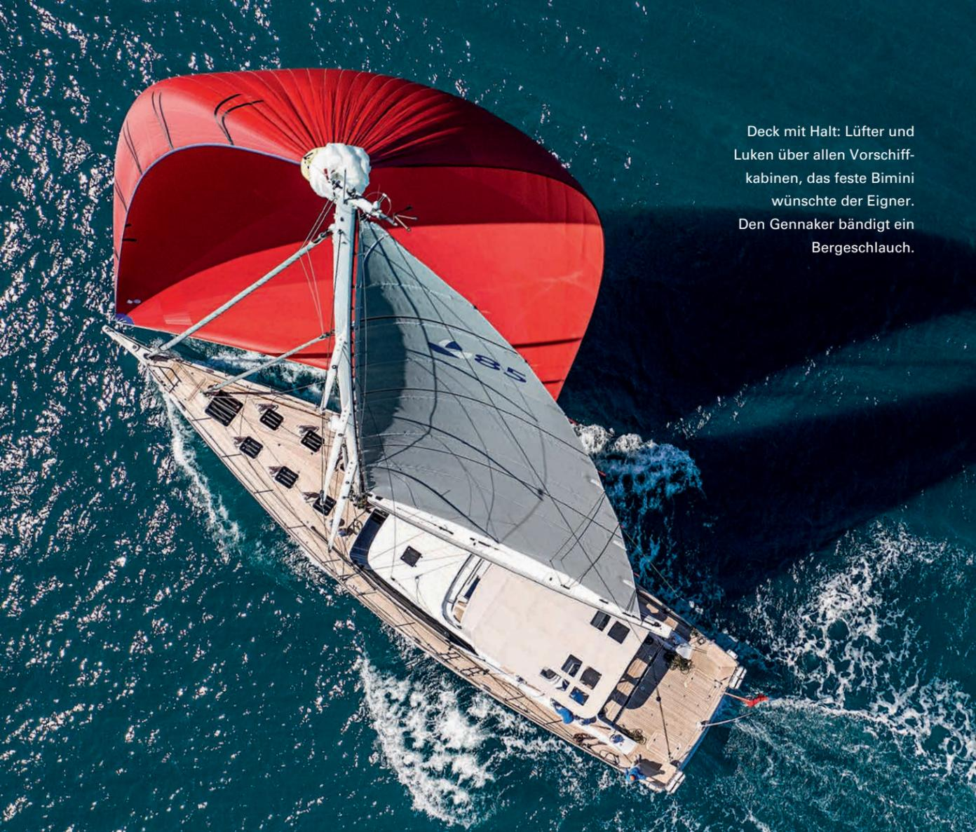
Deck mit Halt: Lüfter und Luken über allen Vorschiffkabinen, das feste Bimini wünschte der Eigner. Den Gennaker bändigt ein Bergeschlauch.
