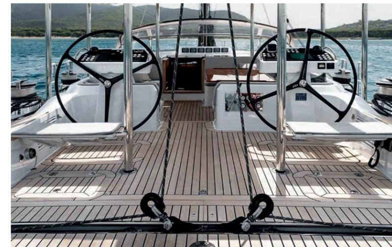
Großzügiges Cockpit: Die Karbonräder von Exit stehen ganze fünf Meter vor dem Heck. Hinter dem Traveller tut sich eine 22 Quadratmeter große Freifläche auf.
