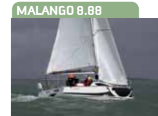
MALANGO 8.88 Lft 8,88 m; Beam 3,45 m; Dspl 2,8 t; pescaggio 0,95-2,25 m
