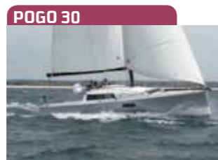
POGO 30 Lft 9,14 m; Beam 3,70 m; Dspl 2,8 t; pescaggio 1,05-2,50 m
