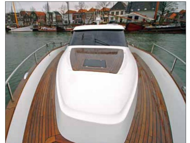
La largeur des passavants permet de circuler facilement jusqu'à la pointe avant. Soulignons aussi la hauteur des pavois, très protecteurs.
