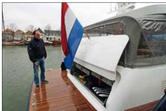
Le tableau arrière dissimule un grand garage à annexe à ouverture électrique.
