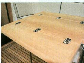
Der als Standard eingebaute Cockpit-Tisch ist zu filigran und sollte durch einen Festeinbau ausgetauscht werden.
